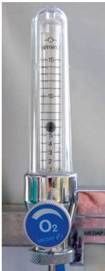
Ryc. 1. Przeływomierz do tlenoterapii - przepływ tlenu ustawiono na 6 l/min
