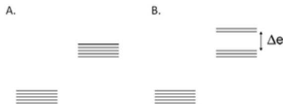
Rys. 1. Rozszczepienie orbitali d metali przejściowych: A. zwiększenie energii orbitali d metalu przejściowego na skutek oddziaływania ze sferycznie symetrycznym polem wytworzonym przez ligandy; B. rozszczepienie energii orbitali d metalu przejściowego na skutek oddziaływania z oktaedrycznym polem wytworzonym przez ligandy.
