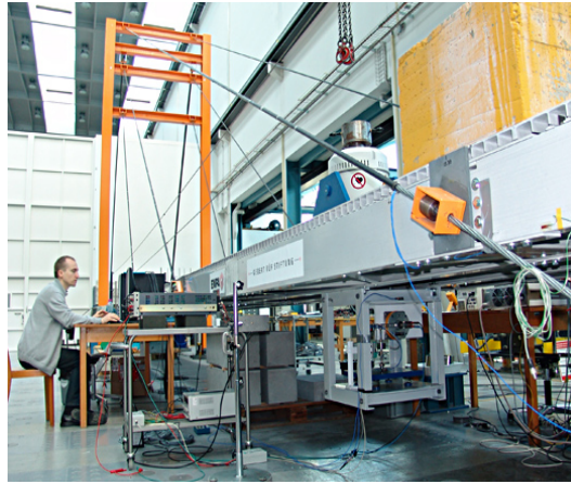
Most laboratoryjny z dołączonym prototypem adaptacyjnego układu TMD, EMPA Dübendorf (na zdjęciu: dr inż. M. Maślanka).
